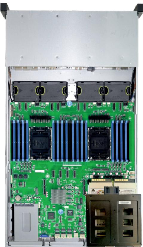
**ПОРТЫ УПРАВЛЕНИЯ****ВМС контроллер** ASPEED AST2500**Выделенный порт IPMI** 1 x Dedicated management GLAN (Встроенный 1 x 1GbE Rj45 для IPMI)**СЛОТЫ РАСШИРЕНИЯ****Riser 1&2 (FH/FL)**
